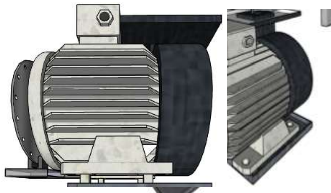
Figura 3.8: Ilustración de motor trifásico de planta didáctica
