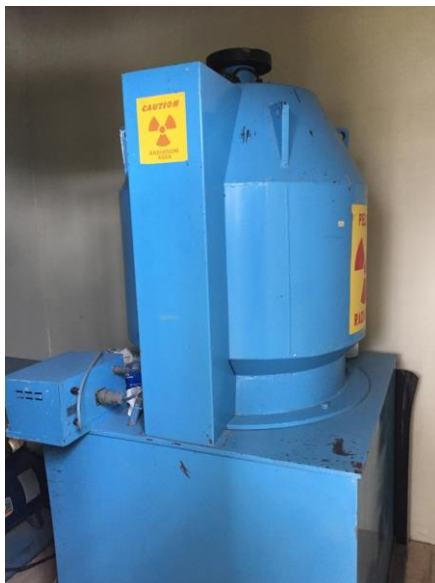
Figura 3. Máquina de rayos gamma en los Laboratorios de Investigación y Aplicaciones Nucleares del Ecuador.
