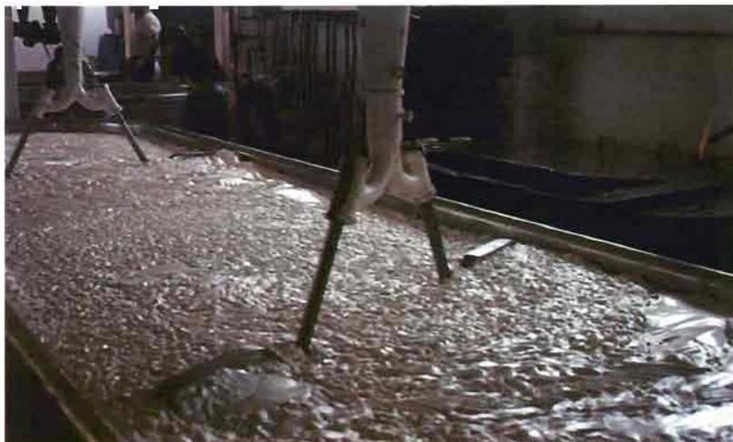
Para conservar el grano individualizado y evitar que se apelmace formando conglomerados y se pierda el ritmo del desuerado, es necesario mantenerlo en constante movimiento por medio de agitación. Esta agitación debe ser lenta al principio y va aumentando de velocidad a medida que la densidad y consistencia del grano aumentan.
